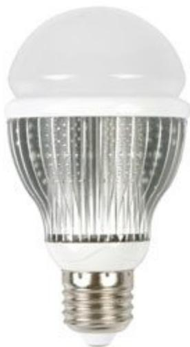
Lampada 6 LED bianco caldo. Alimentazione 230 Vac, potenza: 7,5 watt, flusso luminoso: 550 lumen, angolo di diffusione: 240°, attacco E27.
