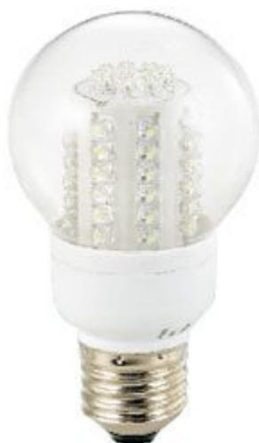
Lampada a bulbo con emissione omnidirezionale dotata di 80 Led bianchi superluminosi da 5 mm. Paragonabile ad una lampadina ad incandescenza tradizionale da 40 W ma, con soli 4 W di assorbimento e oltre 30.000 ore di vita, risulta molto più conveniente in termini di consumo e durata. Dimensioni: 117 x 60 mm compreso l'attacco E27.
