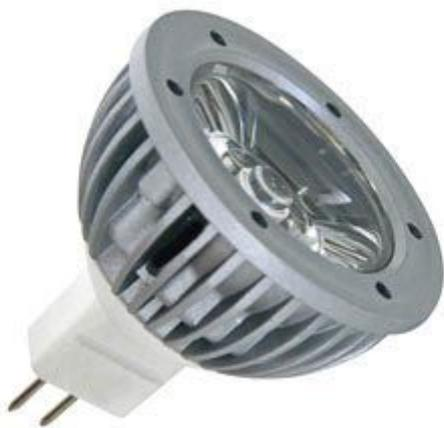
Lampada dotata di LED a luce bianca da 1 W. Flusso luminoso: 50 lumen, angolo di emissione 30°, colore: bianco caldo, attacco MR16/GU5.3. Alimentazione 12 Vac / 12 Vdc, consumo: 1,25 W.
