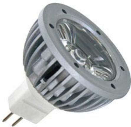
Lampada dotata di LED a luce bianca da 1 W. Flusso luminoso: 55 lumen, angolo di emissione 30°, colore: bianco neutro, attacco MR16/GU5.3. Alimentazione 12 Vac / 12 Vdc, consumo: 1,25 W.
