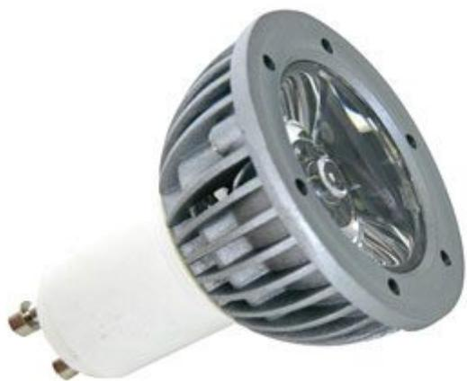
Lampada dotata di LED a luce bianca da 3 W. Flusso luminoso: 100 lumen, angolo di emissione 30°, colore: bianco neutro, attacco GU10. Alimentazione 230 Vac, consumo: 2,7 W.
