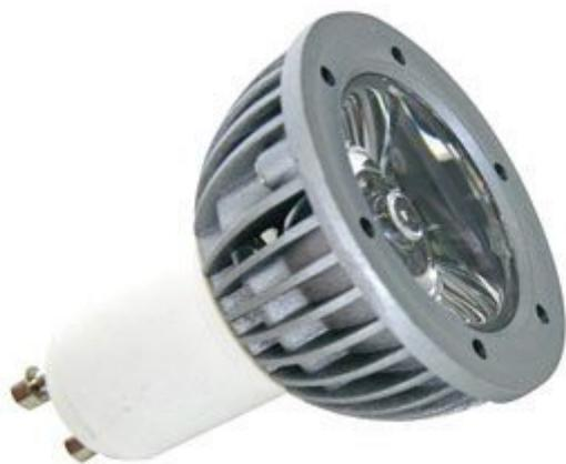
Lampada dotata di LED a luce bianca da 1 W. Flusso luminoso: 50 lumen, angolo di emissione 30°, colore: bianco caldo, attacco GU10. Alimentazione 230 Vac, consumo: 1,25 W.
