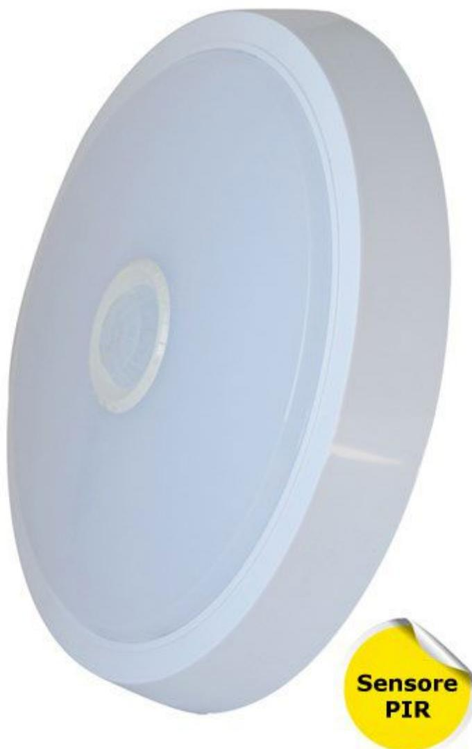
Lampada da soffitto a LED con sensore PIR che ne provoca l'accensione quando qualcuno transita nel suo raggio di azione. Questa caratteristica la rende particolarmente indicata per essere collocata in corridoi, pianerottoli e in qualsiasi altra zona dove è necessaria una illuminazione temporanea. Dispone di timer regolabile, da 30 secondi a 8 minuti, per la durata dell'illuminazione. Portata 1-8 metri regolabile: Alimentazione 220 Vac.
