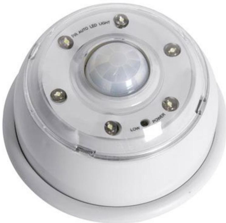
Si accende e si spegne attraverso un sensore PIR (infrarosso passivo), può essere montata a parete o fissata ad un oggetto di metallo grazie alla sua base magnetica. Dispone di interruttore on/off e indicatore di batteria scarica. Tempo di illuminazione (20s, 60s, 90s), sensibilità e luminosità LED regolabili.
