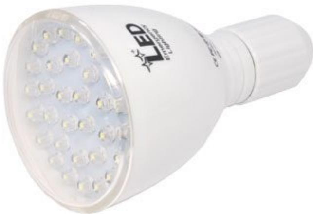
Lampada a luce bianca dotata di 32 LED, batteria ricaricabile interna e interruttore. Può essere utilizzata, a seconda della posizione dell'interruttore (AC-OFF-DC), come lampada o come torcia. Alimentazione 230 Vac, flusso luminoso: 220 lumen, angolo di diffusione: 240°, attacco: E27.
