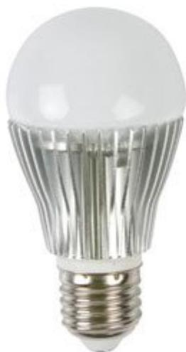
Lampada a luce bianca dotata di 4 LED. Alimentazione 230 Vac, flusso luminoso: 290 lumen, angolo di diffusione: 240°, attacco E27.
