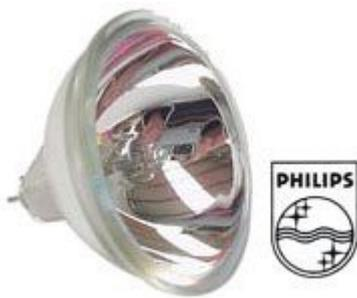
Lampada alogena con proiettore in alluminio per impianti luci. Potenza 150 W, filamento 15V, attacco G6.35, temperatura di colore 3400K, durata 50 ore, dimensioni Ø50 x 40mm.
