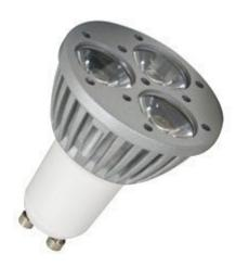
Lampada dotata di 3 LED a luce bianca da 1 W. Intensità luminosa: 175 lumen, angolo di emissione 30°, colore: bianco freddo, attacco GU10. Alimentazione 230 Vac, consumo: 3,48 W.
