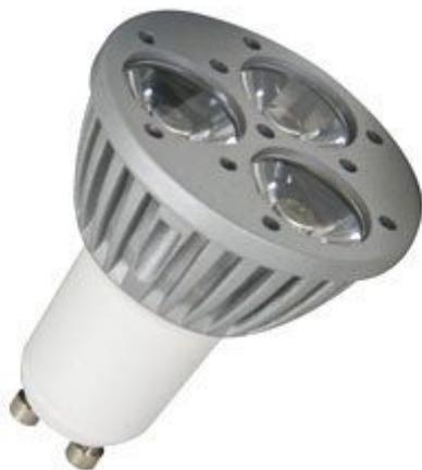
Lampada dotata di 3 LED a luce bianca da 1 W. Flusso luminoso: 150 lumen, angolo di emissione 30°, colore: bianco neutro, attacco GU10. Alimentazione 230 Vac, consumo: 3,48 W.
