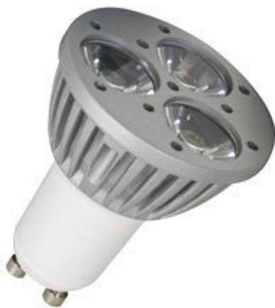
Lampada dotata di 3 LED a luce rossa da 1 W. Flusso luminoso: 120 lumen, angolo di emissione 30°, colore: rosso, attacco GU10. Alimentazione 230 Vac, consumo: 3,48 W.
