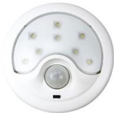
Si accende e si spegne attraverso un sensore PIR (infrarosso passivo), può essere montata a parete e dispone di tre modalità di funzionamento (accensione tramite PIR, sempre accesa e spenta). Tempo di illuminazione (25~30s).
