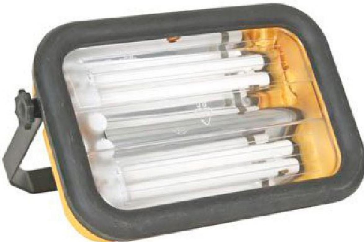
Utilizza due lampade tipo PL-L da 18 watt a risparmio energetico (equivalente a 2 comuni lampade ad incandescenza da 70 watt) che assicurano una ridottissima emissione di calore. Ballast elettronico per una maggiore durata e minori consumi. Può essere montata a parete o soffitto. Lampada di ricambio: EWL12/SP1. Grado di protezione: IP54.
