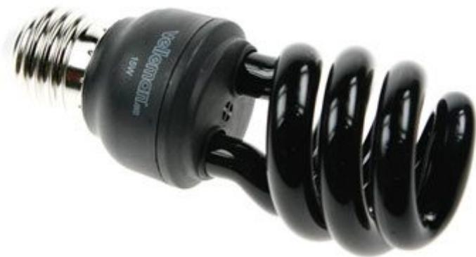
Lampada luce di Wood a risparmio energetico da 15 W / 230 Vac, modello spirale, attacco E-27, 8.000 ore di durata, dimensioni: Ø59 x 132 mm.
