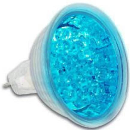
Lampada dotata di 15 LED blu con flusso luminoso di 60 lumen. Alimentazione 12 Vac, attacco MR16 / GU5.3.
