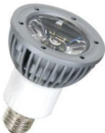
Lampada dotata di LED a luce bianca da 3 W. Alimentazione 230 Vac, consumo: 2,7 W, flusso luminoso: 85 lumen, attacco E14.
