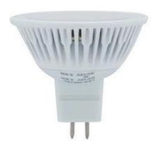
Lampada con attacco MR16 dotata di 3 LED bianco caldo. Paragonabile ad una tradizionale lampadina ad incandescenza da 22 W ma, con soli 5,5 W di assorbimento e oltre 30.000 ore di vita, risulta molto più conveniente in termini di consumo e durata. Dimensioni: Ø 50 x 44 mm.
