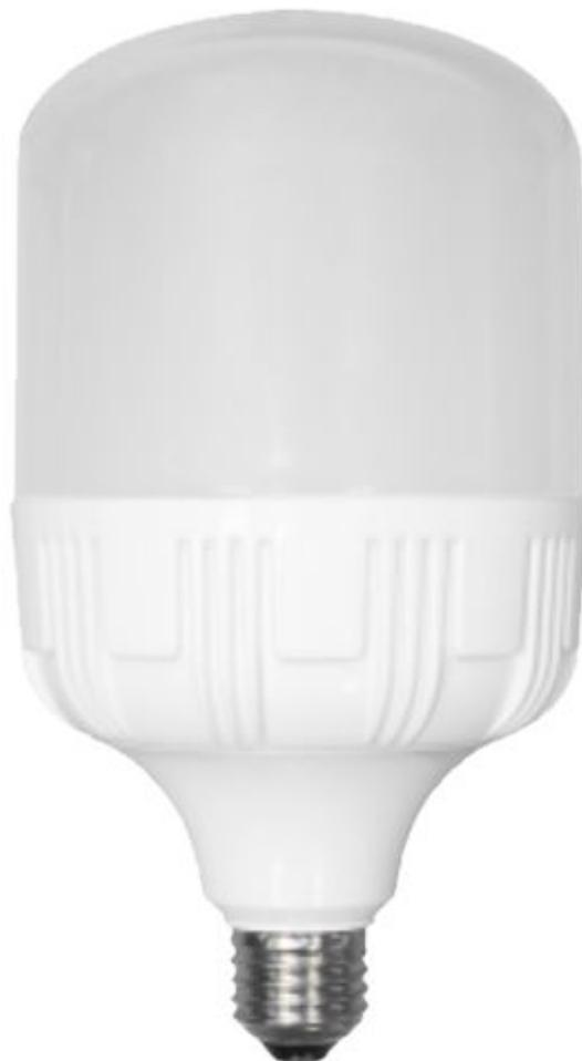
Lampada LED ad alta potenza e basso consumo energetico. Sostituisce direttamente una lampadina a incandescenza da 180 watt. Accensione istantanea, alimentazione: 230 Vac, luce naturale, dimensioni (mm): Ø100x185, attacco E27.
