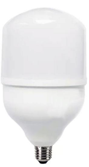
Lampada LED ad alta potenza e basso consumo energetico. Sostituisce direttamente una lampadina a incandescenza da 176 watt. Accensione istantanea, alimentazione: 230 VAC, luce naturale, dimensioni (mm): Ø120x183, attacco E27.
