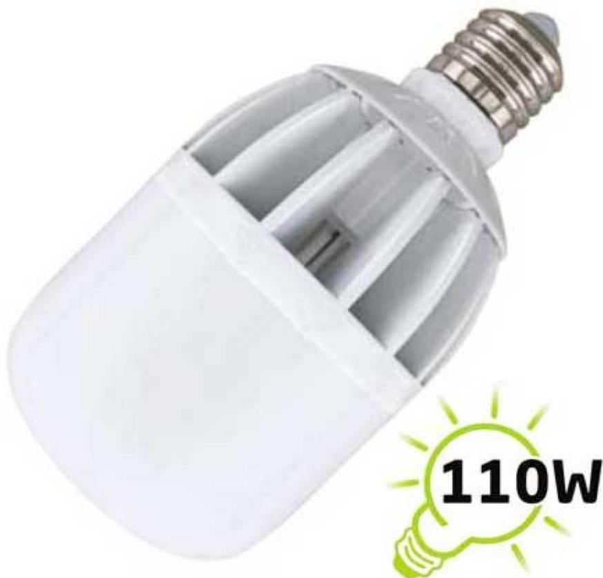
Lampada costituita da 24 LED in SMD tipo 2835 a luce bianco caldo, dotata di corpo in alluminio pressofuso. Alimentazione: 220-240 VAC, dimensioni (mm): 140 (diametro) x 75 (altezza).
