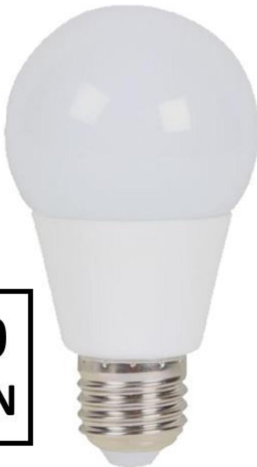
Lampada LED a luce bianco caldo, basso consumo energetico e accensione istantanea. Sostituisce direttamente una lampadina a incandescenza da 90 watt. Alimentazione: 230 Vac, dimensioni (mm): Ø60x110, attacco E27.
