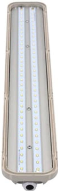
Plafoniera da esterno con lampada composta da 66 LED bianchi in SMD (tipo 2835). Colore: bianco neutro, temperatura colore: 4000 K, flusso luminoso: 1000 lumen, alimentazione 220 Vac, consumo 12 watt. Durata media 30.000 ore di vita.
