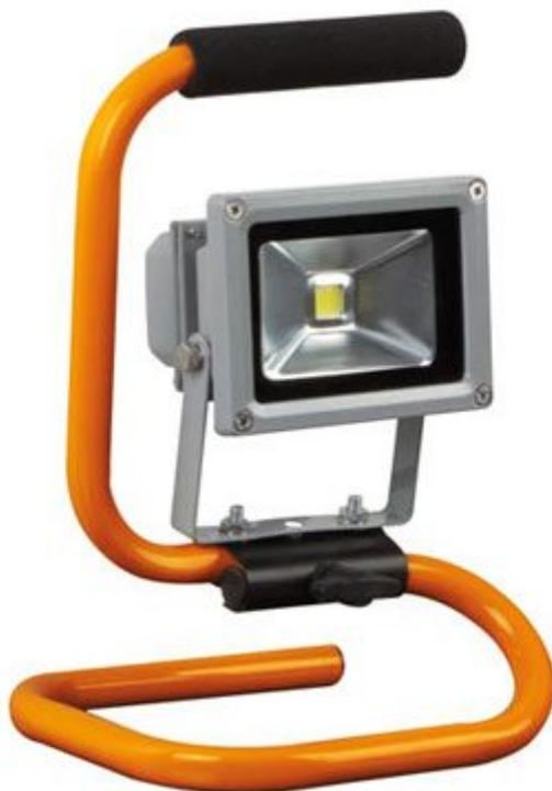
Faro con lampada a LED COB Epistar da 10 watt, corpo in alluminio pressofuso, vetro temperato e supporto con impugnatura in spugna. Adatta per uso esterno (IP65), lunghezza del cavo: 1,5 m.
