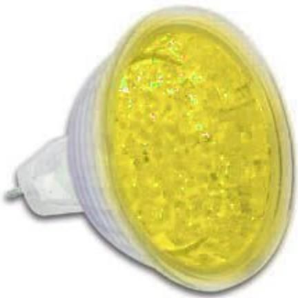
Lampada 12V a led gialli. Caratteristiche: MR16, colore: giallo, alimentazione: 12VAC o 12VDC / 100mA, attacco: MR16/GU5.3, dimensioni: Ø50.7 x 44.5mm, intensità: 7Cd, apertura fascio luminoso: 60°.
