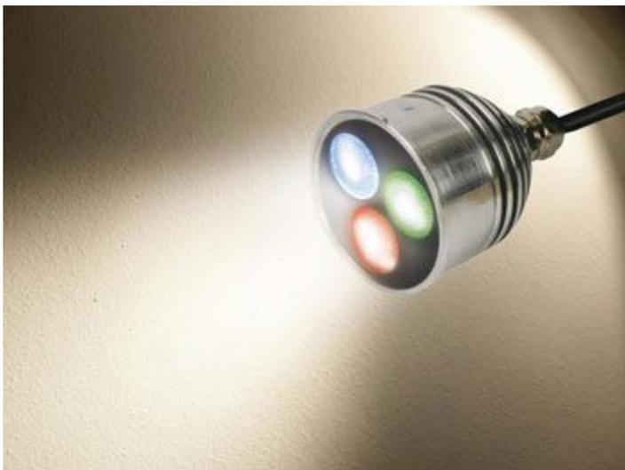
Lampada dotata di 3 LED RGB da 1 W e di corpo in alluminio estruso anodizzato che assicura un'ottima dissipazione termica e notevole robustezza. Alimentazione 48 Vdc/350 mA (fornita dal controller); consumo 3 W; angolo di emissione 45°; formato MR16; dimensioni Ø50 x 71mm. La lampada per funzionare necessita dell'apposito controller codice 8220-LEDA03C (disponibile separatamente) che permette di controllare fino a 12 lampade. Appositamente progettata per locali notturni, bar, ristoranti, ecc.
