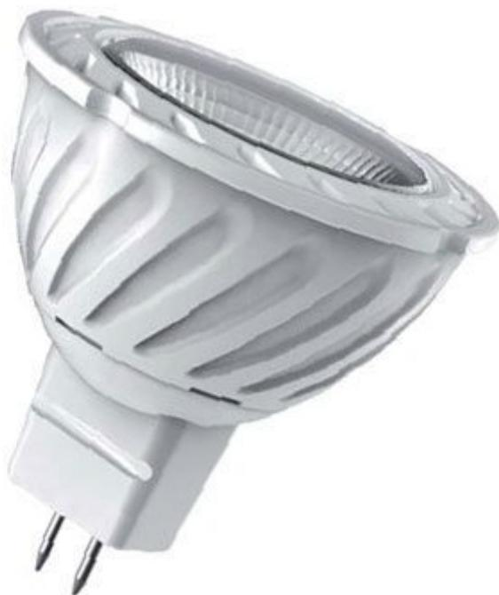
Lampada dotata di LED COB bianco neutro da 6 W, corpo in alluminio pressofuso rivestito in termoplastica bianca. Flusso luminoso: 410 lumen, angolo di emissione 100°, attacco MR16/GU5.3. Alimentazione 12 Vac / 12 Vdc.
