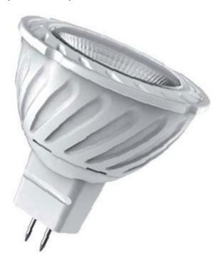
Lampada dotata di LED COB bianco neutro da 6 W, corpo in alluminio pressofuso rivestito in termoplastica bianca. Flusso luminoso: 420 lumen, angolo di emissione 38°, attacco MR16/GU5.3. Alimentazione 12 Vac / 12 Vdc, consumo: 6,25 W.
