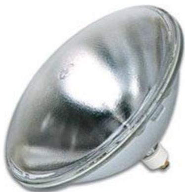
Lampada PAR56 con attacco GX16D per proiettore VDLP56SC2. Alimentazione: 240 Vac, potenza: 300 W, vita media: 3000 ore, temperatura colore (K): 2900.
