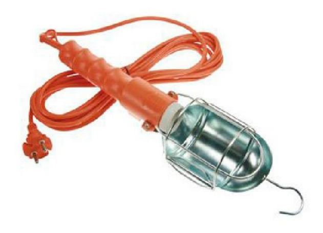
Lampada portatile con gabbia metallica e e gancio. È dotata di cavo lungo 5 metri e spina shuko e di interruttore a tenuta stagna. Alimentazione 220Vac, potenza massima lampadina 60 W (non inclusa). Attacco E27.
