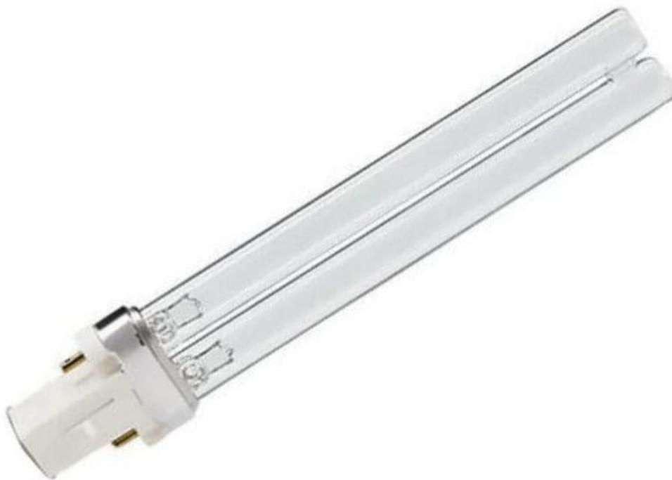
Lampada ultravioletta di lunghezza d'onda di 2.537 Angstrom (253,7 nm) utilizzata nei settori di sterilizzazione e sanificazione. L'emissione UV-C consente di abbattere microbi, germi e virus nell'aria e sulle superfici. La lampada è "Ozone free" con vetro al quarzo selettivo. Per il suo funzionamento necessita soltanto di uno starter e di un reattore come una normale lampada fluorescente o di un ballast di tipo elettronico. Potenza 7 Watt, attacco G23, vita media 4000 ore.
