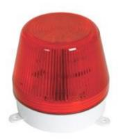
Ideale per sistemi di allarme, per segnalare pericoli, per attrarre l'attenzione, ecc.. Contenitore a tenuta stagna con coperchio di materiale acrilico trasparente e base in ABS. Alimentazione: 220 Vac.
