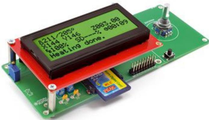
Dotata di encoder rotativo, display LCD e slot per schede SD card, questa scheda permette di controllare la stampante 3Drag e stampare senza l'ausilio di un computer. Consente di avere sotto controllo e in tempo reale, temperatura, accelerazione, velocità, flow rate, preriscaldamento, blocco e rilascio dei motori, posizionamento del piano o dell'estrusore. Permette inoltre l'avvio automatico o manuale della stampa. La scheda viene alimentata direttamente dalla scheda di controllo della 3DRAG.
