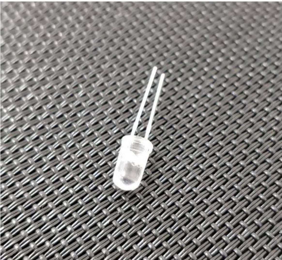
LED giallo che simula la fiamma tremolante di una candela. Lunghezza d'onda 590 nm, colore involucro: trasparente, diametro: 5 mm, alimentazione: 3-3,4 volt, corrente: 20 mA.
