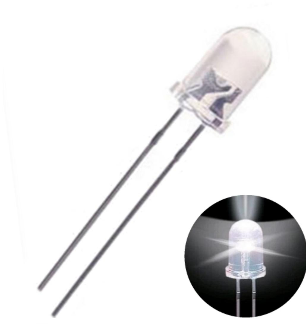
Led 5 mm THT a luce bianca fredda con luminosità di 20.000mcd ( $i_f=20\text{mA}$ ), tensione diretta: 5,5-6,5V e angolo di emissione: 60°.
