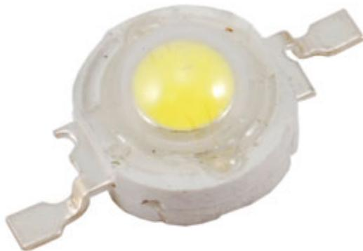
LED bianco neutro con potenza di 1 watt, temperatura colore: 4000 K (deviation of 5%), intensità luminosa: 80-90 Lumen (350 mA), angolo d'emissione: 180°, alimentazione (VF): 3,15 Vdc - 3,4 Vdc, corrente: (IF): 350 mA, temperatura di funzionamento: da -20°C a +60°C, temperatura di stoccaggio: da 20°C a 60°C, vita media: 50.000 ore.
