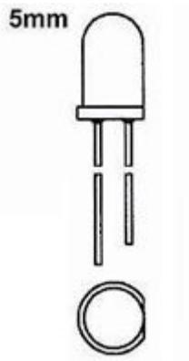
LED bianco diametro da 5 mm con intensità luminosa da 780 mcd ( $I_f = 20\text{mA}$ ), angolo di osservazione:  $90^\circ$  e alimentazione: 3,2 Vdc.
