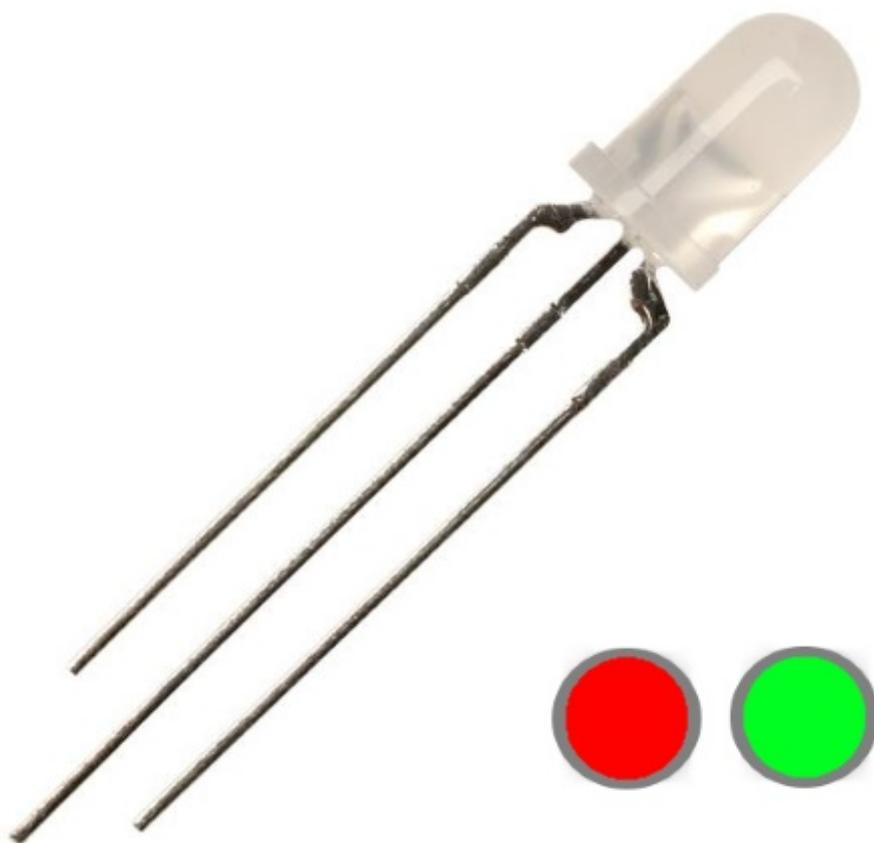
Led bicolore 5 mm a diffusione. Colore: rosso-verde; intensità luminosa ( $i_f=20\text{mA}$ ): 60 mcd (rosso) e 50 mcd (verde). Angolo di apertura 60 gradi, catodo comune
