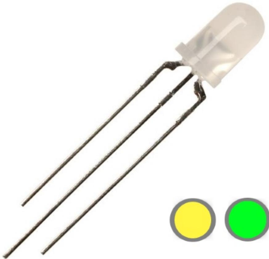
Led bicolore 5 mm a diffusione. Colore: verde-giallo; intensità luminosa ( $i_f=20\text{mA}$ ): 50 mcd (verde) e 40 mcd (giallo). Angolo di apertura 60 gradi, catodo comune.
