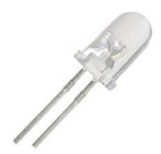
Led a luce blu superluminoso. Specifiche: diametro: 5 mm, colore involucro: bianco, colore luce emessa: blu, lunghezza d'onda: 460~475 nm, intensità luminosa: (Vf = 3,4 V): 8000 mcd (20 mA), angolo di emissione: 13°.
