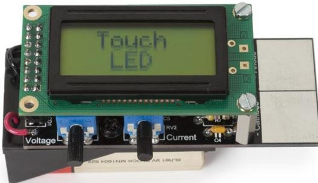
Il LED Buddy è un piccolo strumento in grado di fornire un aiuto alla progettazione, test e calcolo dei circuiti elettronici dove vengono impiegati i led. Mettendo a contatto il led sui PAD viene indicata la polarità del componente, la tensione diretta e viene calcolata la resistenza da inserire in serie per fornire la giusta corrente.
