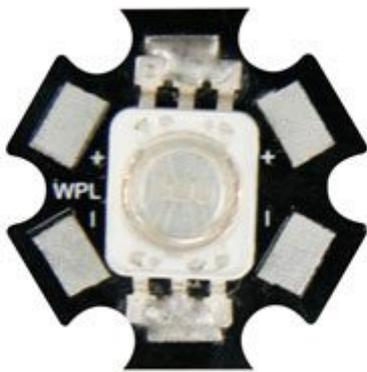
Super Led rosso ad alta luminosità, potenza 3 W, oltre 50.000 ore di funzionamento. Colore rosso, lunghezza d'onda dominante: 625 nm , flusso luminoso: 100 lumen, angolo di osservazione: 90°, resistenza termica: 48°C/W, alimentazione: 2,2 Vdc, corrente: 1 A, potenza: 4,8 W, montaggio: SMT, nessuna emissione UV. Non utilizzare il LED senza un dissipatore (non compreso).
