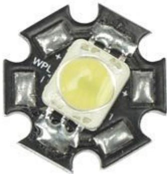
Super Led bianco, potenza 3 W, oltre 50.000 ore di funzionamento. Specifiche: colore bianco puro - flusso luminoso: 170 lm - angolo di osservazione: 110° - resistenza termica: 48°C/W - corrente: 1 A - tensione: 3,5 V - temperatura di colore: 6000 K - potenza dissipata: 4,8 W - temperatura Tj: max. 125°C. Per il pilotaggio utilizzare il kit [K8071](#) o la versione montata [VM143/3W](#). **Attenzione:** non deve essere utilizzato senza dissipatore.
