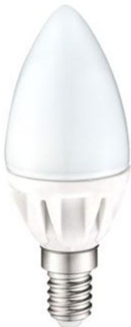
Lampada LED bianco caldo, dotata di corpo in ceramica, basso consumo energetico e accensione istantanea al 100%. Sostituisce direttamente le lampadine a incandescenza. Alimentazione: 220 - 240 Vac, dimensioni: Ø37,5x131 mm, attacco E14.
