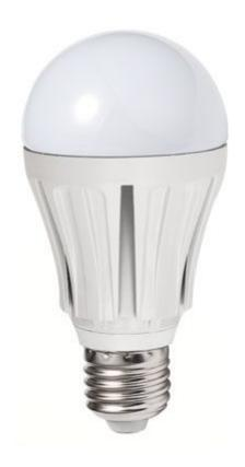
Lampada LED bianco neutro, dotata di corpo in alluminio pressofuso, basso consumo energetico e accensione istantanea al 100%. Sostituisce direttamente le lampadine a incandescenza. Alimentazione: 175 - 250 Vac ~ 50 Hz , dimensioni: Ø60x120 mm, attacco E27.
