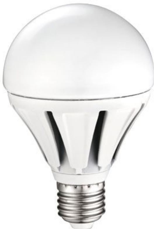
Lampada LED bianco caldo, dotata di corpo in alluminio pressofuso, basso consumo energetico e accensione istantanea al 100%. Sostituisce direttamente le lampadine a incandescenza. Alimentazione: 100 - 250 Vac ~ 50 Hz , dimensioni: Ø95x155 mm , attacco E27.
