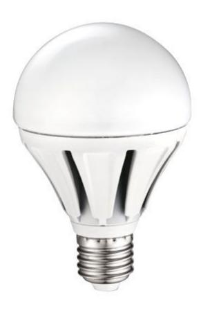
Lampada LED bianco neutro, dotata di corpo in alluminio pressofuso, basso consumo energetico e accensione istantanea al 100%. Sostituisce direttamente le lampadine a incandescenza. Alimentazione: 220 - 240 Vac ~ 50 Hz , dimensioni: Ø95x155 mm, attacco E27.
