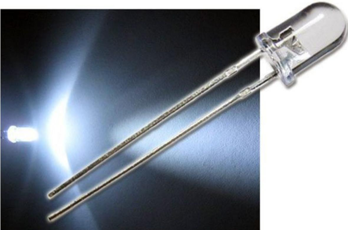
LED lampeggiante bianco. Intensità luminosa: 1200-1400 MCD, colore involucro: trasparente, diametro: 5 mm, alimentazione: 3-3,4 volt, corrente: 20 mA, frequenza lampeggio: circa 1,5 Hz (90 lampeggi al minuto)
